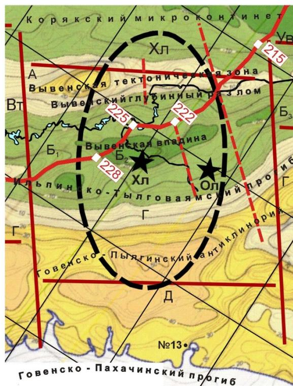
**Рис. 8.** Карта гравитационного поля [Белоусов и др., 2005, с дополнениями]. (Условные обозначены см. на рис. 6). Жёлтым и коричневым цветом обозначено положительное поле, зелёным – отрицательное, красным – нарушения интерпретационные
