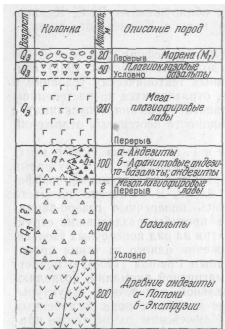
Рис. 3. Схематический разрез вулканогенных образований юго-восточной окраины Ключевского дола
