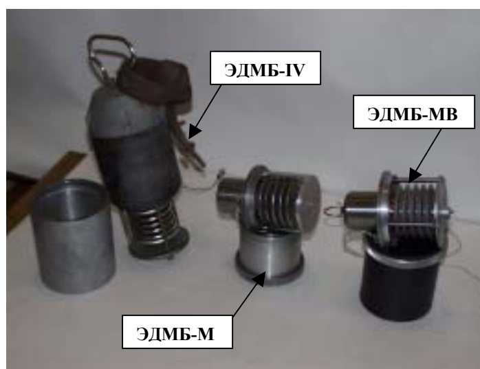
Рис.2.1. Общий вид электродинамических микробарографов, которые применялись для регистрации вулканических АС.
