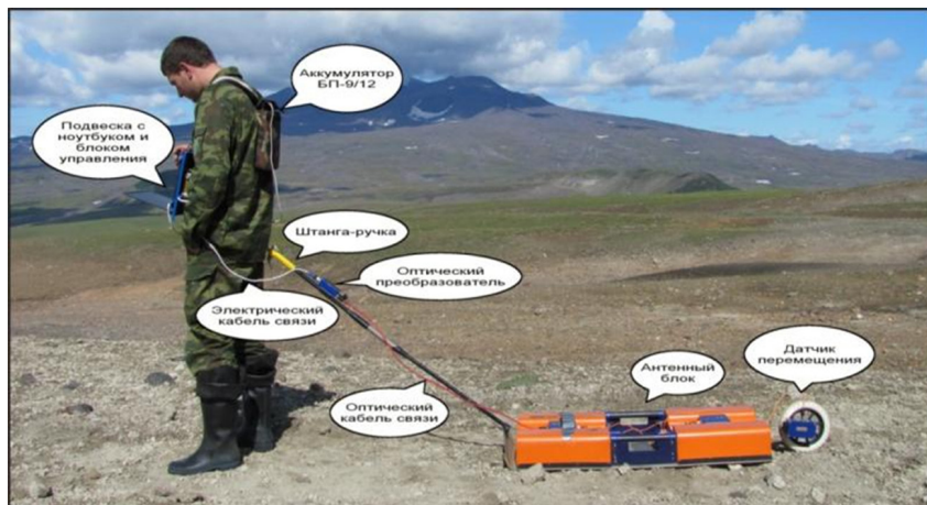
Рис. 2.1. Оператор с георадаром «ОКО-250» в районе Мутновско-Гореловской группы вулканов (п-ов Камчатка)
