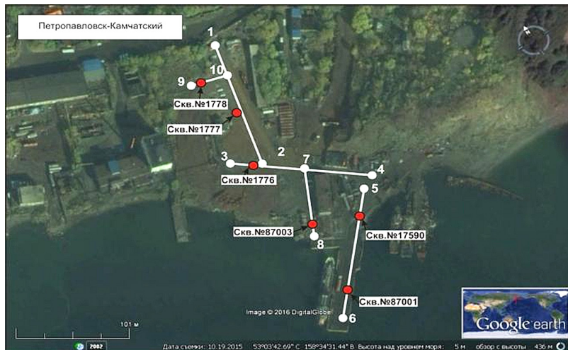
Рис. 3.6. Детальная схема участка работ (космический снимок Image Landsat, Data SIO, NOAA, U.S. Navy, NGA, GEBCO www.earth.google ): точки 1-6 – георадиолокационные профили; скв. №1778 и т.п. – скважина и ее номер
