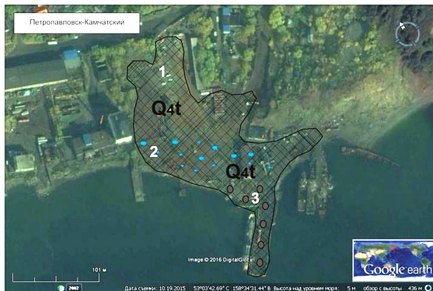
Рис. 3.12. Схема распространения рыхлых четвертичных отложений на берегу бухты Моховая ( Q_{4t} ): 1 – дресвяно-щебенистый грунт; 2 – дресвяно-щебенистый грунт с морскими отложениями; 3 – дресвяно-щебенистый грунт с валунами андезита с песком до 5%
