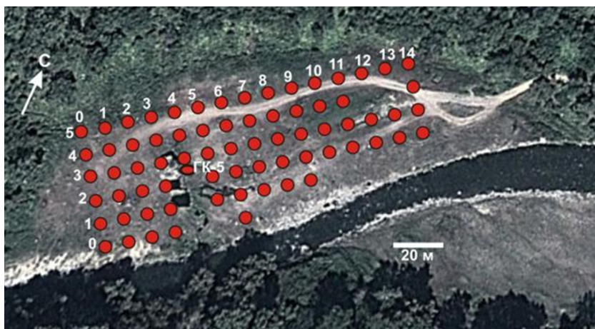
Рис. 3.68. Схема расположения георадарных профилей на участке «Теплые земли» (Карымшинская гидротермальная система, Камчатка) Цифрами обозначены номера профилей: от 0 до 5 – магистральные, от 0 до 14 – ортогональные
