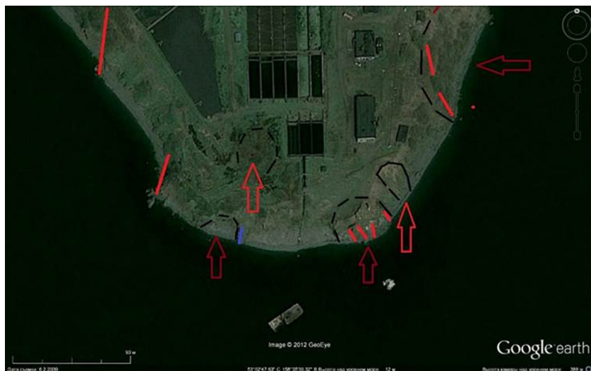
Рис. 3.16. Расположение известных оползневых тел в южной части участка. Темно-красными стрелками обозначены скальные оползни, светло-красными – оползни в рыхлых отложениях. Черными линиями показаны оползневые цирки, красные линии – крупные зияющие трещины отрыва, голубые – дайки, армирующие склон
