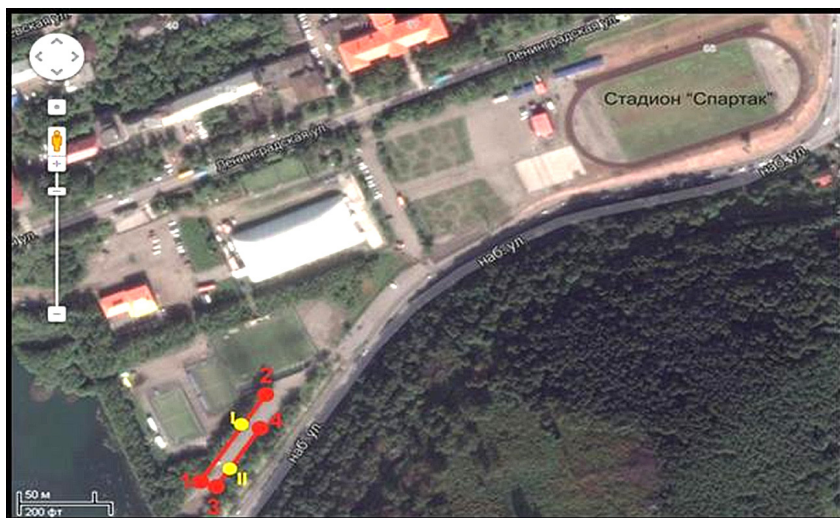
Рис. 2.6. Схема расположения георадиолокационных профилей: 1-2 – профиль 1 (52 м); 3-4 – профиль 2 (39 м); I – скважина С-5329/15; II – скважина С-5332/20. Космический снимок Image Landsat, Data SIO, NOAA, U.S. Navy, NGA, GEBCO www.eart.google
