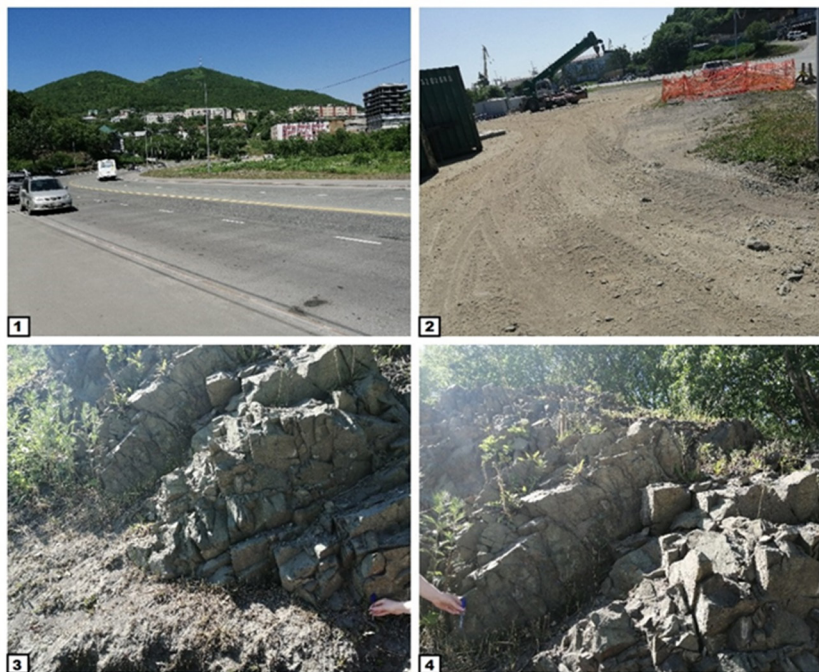
Рис. 3.29. Район проведения работ: 1 – строительное освоение территории; 2 – насыпные грунты; 3 и 4 – эффузивно-пирокластические породы, метаморфизованные в зеленокаменные сланцы
